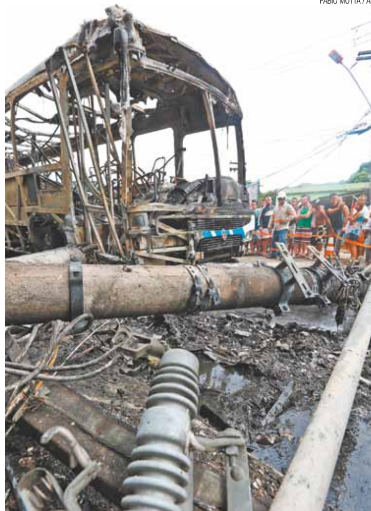
Destroços - Transformador caiu sobre o coletivo e iniciou as chamas
